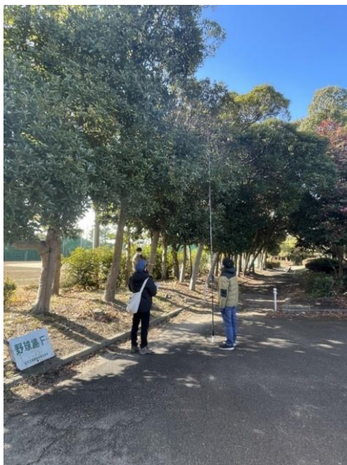
図-3.2.1 伸縮性メジャーポールと巻き尺を用いた測定の様子
